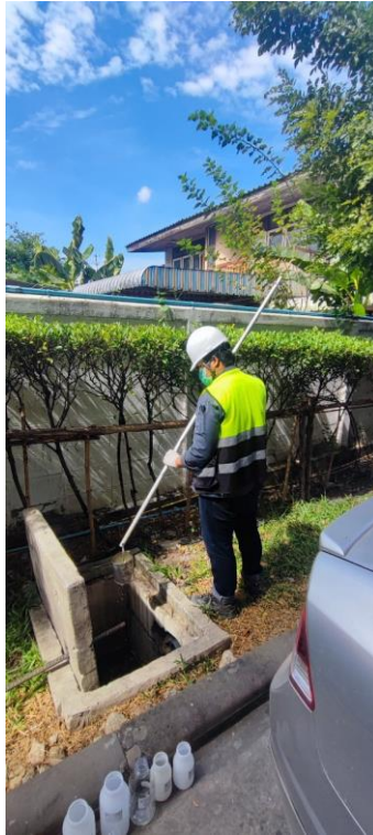
บ่อพักน้ำก่อนเข้าระบบบำบัดน้ำเสีย
