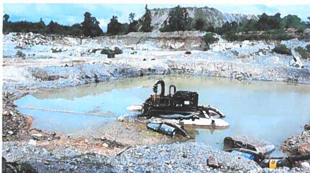
ภาพที่ ๑๓ มีระบบสูบน้ำเพื่อลดปริมาณน้ำในเหมือง
