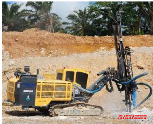
รูปที่ 26 เครื่องเจาะระเบิดที่ติดตั้งอุปกรณ์เก็บฝุ่นไว้บริเวณหัวเจาะ
