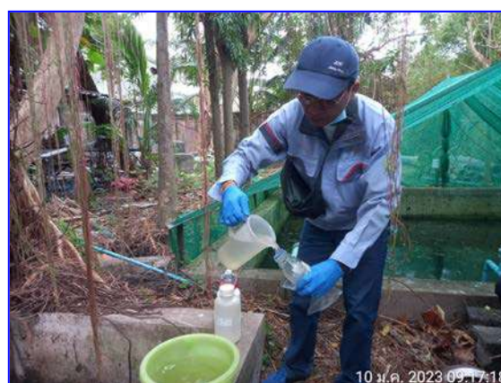
รูปที่ 3.1 การเก็บตัวอย่างน้ำเข้าระบบบำบัด
