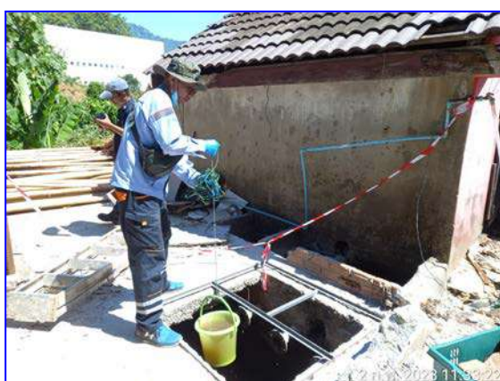
รูปที่ 3.1 การเก็บตัวอย่างน้ำเข้าระบบบำบัด
