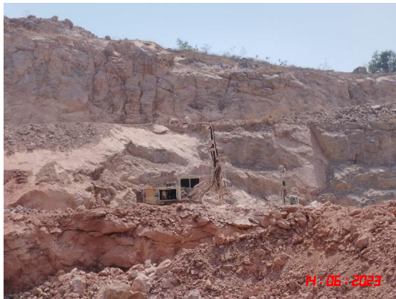
รูปที่ 10 รถเจาะรูระเบิดที่มีอุปกรณ์เก็บฝุ่นติดไว้กับหัวเจาะ
