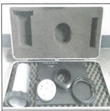
รูปที่ 3-2 แสดงอุปกรณ์ภายในเครื่อง High Volume Air Sampler สำหรับตรวจวัด TSP และชุดปรับเทียบอัตราการไหลของเครื่อง (Orifice Transfer Standard) ตามมาตรฐานการตรวจวัด TSP
