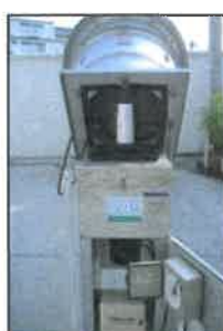
รูปที่ 3-3 การปรับเทียบและติดตั้งเครื่องมือเก็บตัวอย่างฝุ่นละอองขนาดไม่เกิน 10 ไมครอน (High Volume Air Sampler)
