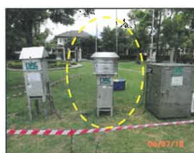
รูปที่ 3-3 การปรับเทียบและติดตั้งเครื่องมือเก็บตัวอย่างฝุ่นละอองขนาดไม่เกิน 10 ไมครอน (High Volume Air Sampler)
