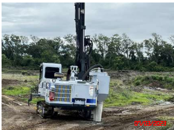
รูปที่ 4 เครื่องเจาะรูระเบิดที่มีอุปกรณ์เก็บฝุ่นติดไว้ที่หัวเจาะ
