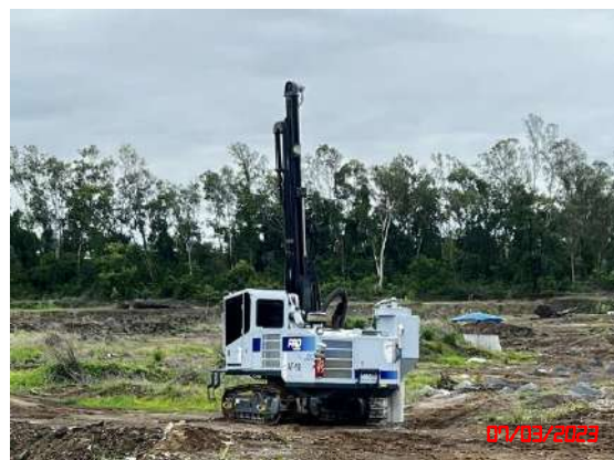
รูปที่ 4 เครื่องเจาะรูระเบิดที่มีอุปกรณ์เก็บฝุ่นติดไว้ที่หัวเจาะ
