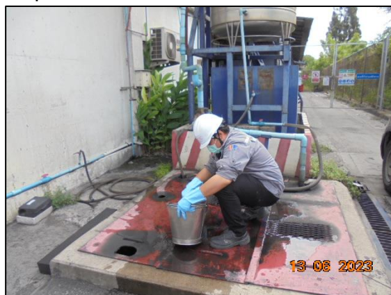
รูปที่ 3.1 การเก็บตัวอย่างคุณภาพน้ำทิ้งบริเวณจุดที่ 1 บ่อบำบัดน้ำเสียก่อนเข้าระบบบำบัดและกำจัดไขมันของท่าเรือ B1
