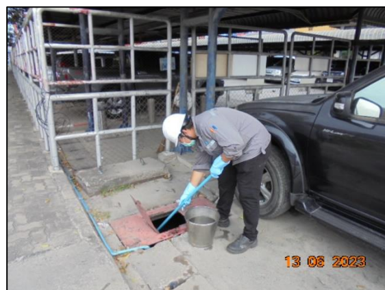
รูปที่ 3.2 การเก็บตัวอย่างคุณภาพน้ำทิ้งบริเวณจุดที่ 2 บ่อบำบัดน้ำเสียสุดท้ายหลังจากผ่านการบำบัดและ กำจัดไขมันของท่าเรือ B1 ก่อนถูกส่งไปยังระบบบำบัดน้ำเสียส่วนกลางของท่าเรือแหลมฉบังต่อไป
