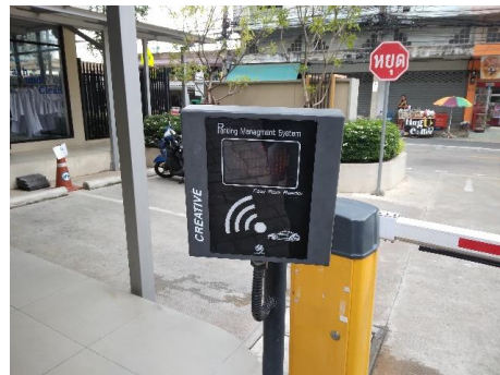
รูปที่ 14 ระบบ RFID Smart Card บริเวณทางเข้า-ออก
