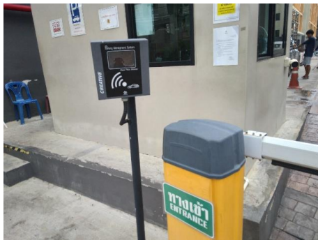
รูปที่ 14 ระบบ RFID Smart Card บริเวณทางเข้า-ออก
