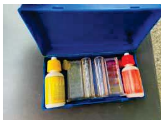
ภาพที่ 3.5.4-3 วิธีการตรวจวัด pH และ Chlorine
