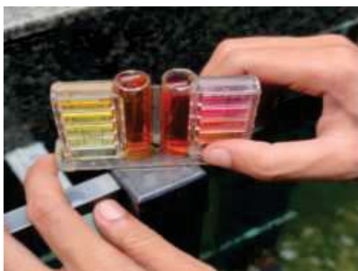
ภาพที่ 3.5.4-3 วิธีการตรวจวัด pH และ Chlorine
