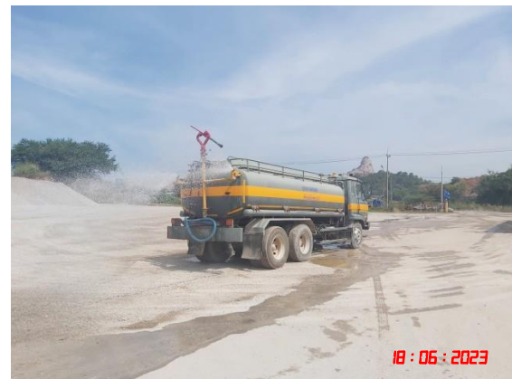
รูปที่ 11 ระบบป้องกันผลกระทบสิ่งแวดล้อมบริเวณโรงโม่หิน
