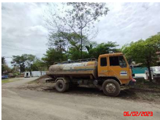
รูปที่ 19 รถฉีดพรมน้ำบริเวณเส้นทางขนส่งแร่
