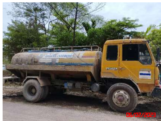
รูปที่ 19 รถฉีดพรมน้ำบริเวณเส้นทางขนส่งแร่
