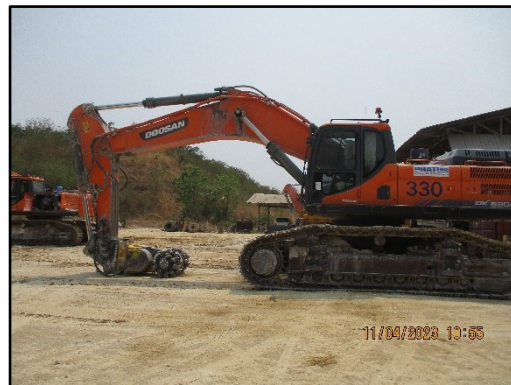
ภาพที่ 2.5 การนำ Hydraulic Breaker ติดห้วงัดมาใช้ในการทำเหมือง
