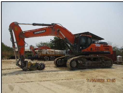
ภาพที่ 2.5 การนำ Hydraulic Breaker ติดห้วงัดมาใช้ในการทำเหมือง
