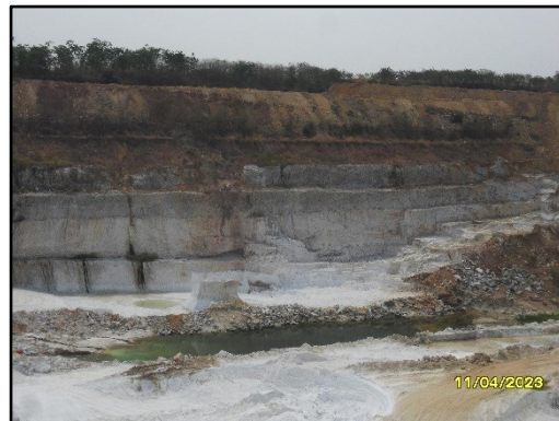
ภาพที่ 2.4 การเปิดหน้าเหมืองในแบบลักษณะขั้นบันได
