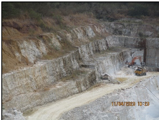
ภาพที่ 2.4 การเปิดหน้าเหมืองในแบบลักษณะขั้นบันได
