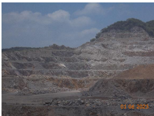
รูปที่ 2-2 ลักษณะการทำเหมืองแบบขั้นบันได เหมืองแร่หินปูน
