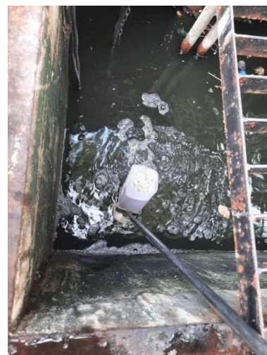
รูปที่ 3.3 ภาพแสดงการเก็บตัวอย่างน้ำจุดที่ 2 คุณภาพน้ำเสียก่อนผ่านระบบบำบัดน้ำเสีย บ่อสูบน้ำเสีย 2
