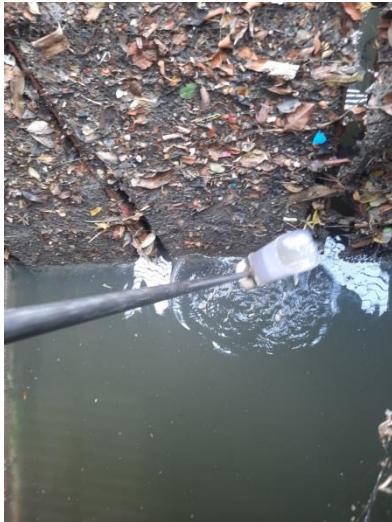
รูปที่ 3.4 ภาพแสดงการเก็บตัวอย่างน้ำจุดที่ 3 คุณภาพน้ำเสียก่อนผ่านระบบบำบัดน้ำเสีย บ่อสูบน้ำเสีย 3
