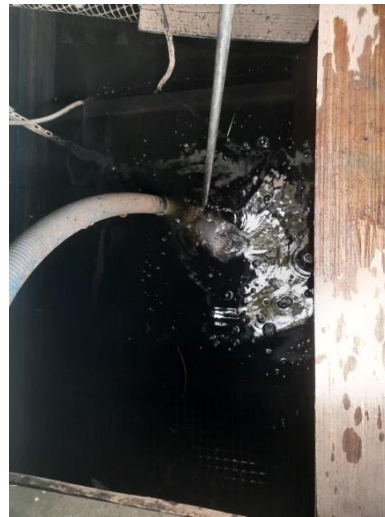
รูปที่ 3.5 ภาพแสดงการเก็บตัวอย่างน้ำจุดที่ 4 คุณภาพน้ำทิ้ง บ่อตรวจคุณภาพน้ำ 1
