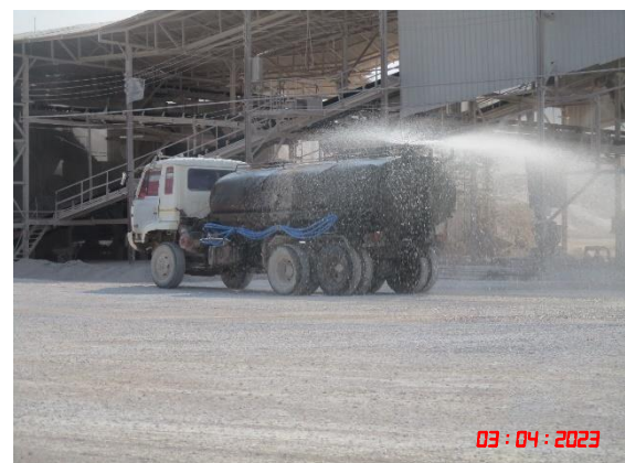
รูปที่ 8 การฉีดพรมน้ำบริเวณโรงโม่หิน และเส้นทางลำเลียงหิน
