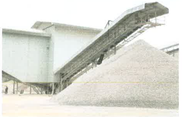
รูปที่ 18 การปิดคลุมสายพานลำเลียง
