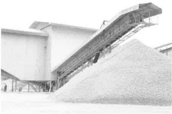
รูปที่ 19 การปิดคลุมสายพานลำเลียง
