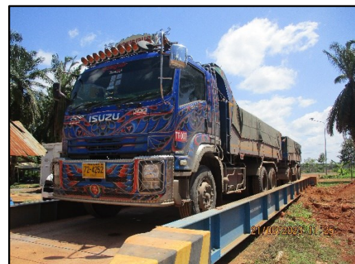
ภาพที่ 2.25 การใช้ผ้าใบปิดคลุมกระบะท้ายรถบรรทุกให้มิดชิด
