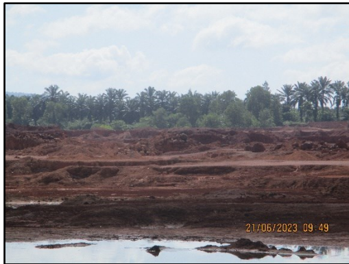
ภาพที่ 2.21 การทำเหมืองแบบชั้นบันได
