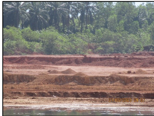
ภาพที่ 2.21 การทำเหมืองแบบชั้นบันได
