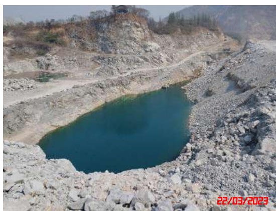
รูปที่ 23 บ่อรับน้ำ (Sump)
