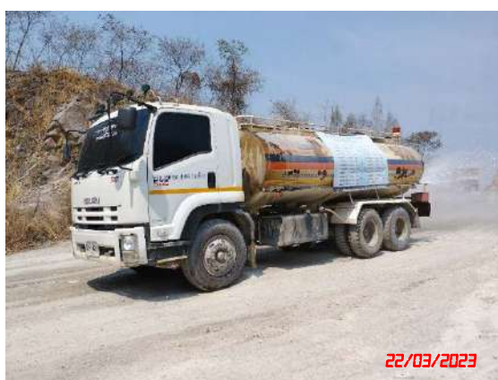
รูปที่ 9 การฉีดพรมน้ำเส้นทางขนส่งแร่
