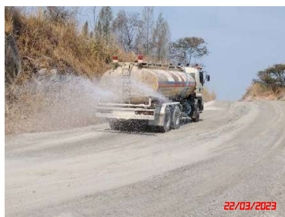
รูปที่ 9 การฉีดพรมน้ำเส้นทางขนส่งแร่
