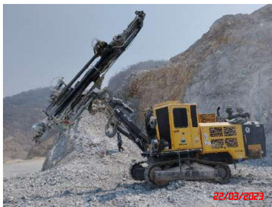
รูปที่ 22 เครื่องเจาะระเบิดแบบดินตะขบ
