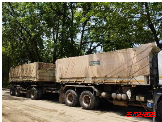
รูปที่ 17 การใช้ผ้าใบปิดคลุมท้ายกระบะรถบรรทุก
