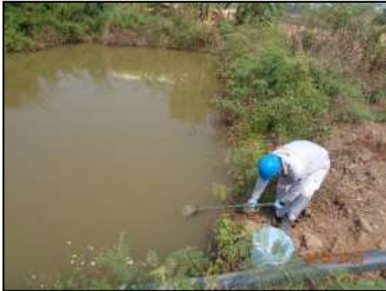
ภาพที่ 3.18 การตรวจวัดคุณภาพน้ำบ่อดักตะกอน ที่เก็บกองเปลือกดิน (บ่อ 1)
