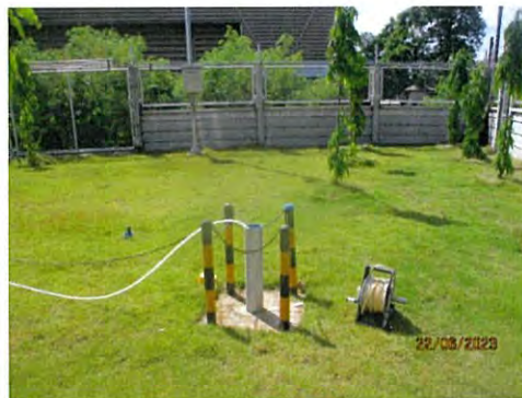
ภาพที่ 2-11 บ่อสังเกตการณ์ (Monitoring Well)
