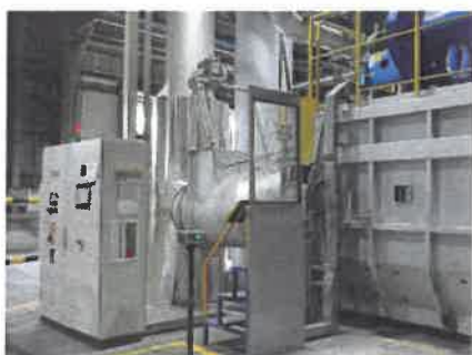
รูปที่ 2-26 อุปกรณ์กันความร้อนหน้าเตาหลอม
