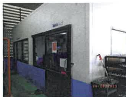
รูปที่ 2-29 ห้องครอบเสียงดังหรือฉนวนป้องกันเสียงดัง (Noise Insulation)
