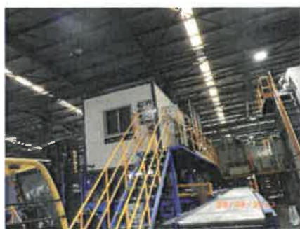
รูปที่ 2-29 ห้องครอบเสียงดังหรือฉนวนป้องกันเสียงดัง (Noise Insulation)
