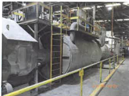
รูปที่ 2-5 ระบบ After Burner ที่เตาอบเศษชิ้นล้าง
