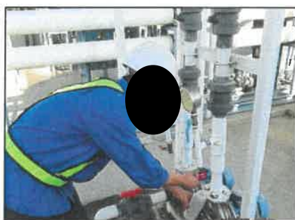
รูปที่ 3-16 แสดงการเก็บตัวอย่างคุณภาพน้ำทิ้งในถังพักน้ำทิ้ง จากการล้างย้อนระบบกรอง (Backwash waste Tank) ของโครงการฯ ในระยะดำเนินการ
