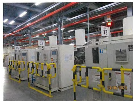
ภาพที่ 2.2-3 การติดตั้งเครื่องจักรภายในอาคารและติดตั้งอุปกรณ์เพื่อควบคุมเสียงที่มีแหล่งกำเนิดจากเครื่องจักร
