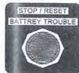
สวิทช์ปุ่มกด STOP / RESET BATTERY TROUBLE
