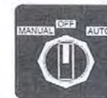
สวิทช์โหมด MAN-OFF-AUTO เลือก OFF "หยุดการทำงาน"
