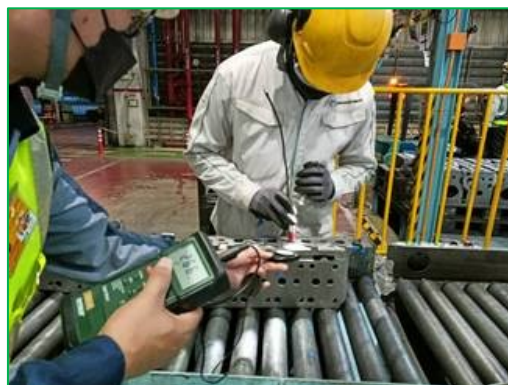
ภาพที่ 3.11 ภาพแสดงการตรวจวัดระดับความเข้มแสงสว่างในพื้นที่ทำงาน
