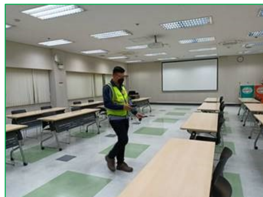
ภาพที่ 3.11 ภาพแสดงการตรวจวัดระดับความเข้มแสงสว่างในพื้นที่ทำงาน
