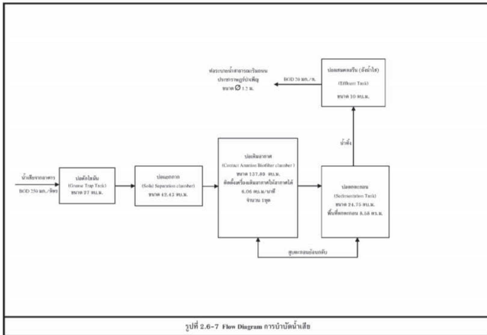
ภาพที่ 1.3.3-2 การทำงานของระบบบำบัดน้ำเสีย
