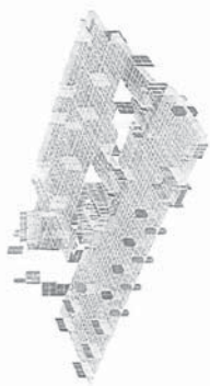
รูปที่ 4: การจำลองที่ขยายรายละเอียดเป็น Plate Elements
