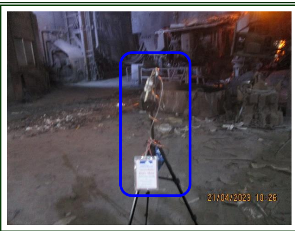
รูปที่ 4-60 ตรวจวัดฝุ่นละอองบริเวณเตาหลอมเหล็ก เก็บตัวอย่างในวันที่ 21 เมษายน 2566
