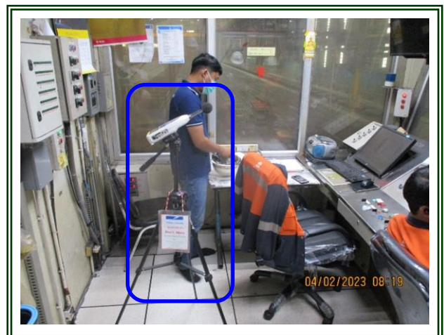
รูปที่ 4-87 ตรวจวัดระดับเสียงในพื้นที่การทำงาน บริเวณ Pendulum Shear (ห้องควบคุม) ตรวจวัดในวันที่ 4 กุมภาพันธ์ 2566
