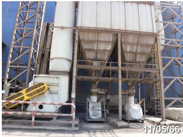
รูปที่ 3-11 ระบบ Dust Collector ของอาคารเท Slag และถูกเก็บรวบรวมฝุ่นรอส่งไปกำจัด
