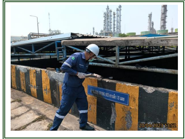
รูปที่ 4-59 เก็บตัวอย่างกากของเสีย Sludge Drying Bed เก็บตัวอย่างในวันที่ 20 เมษายน 2566
