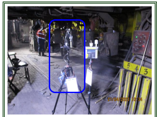
รูปที่ 4-61 ตรวจวัดฝุ่นละอองบริเวณแท่นรีดเหล็ก เก็บตัวอย่างในวันที่ 21 เมษายน 2566
