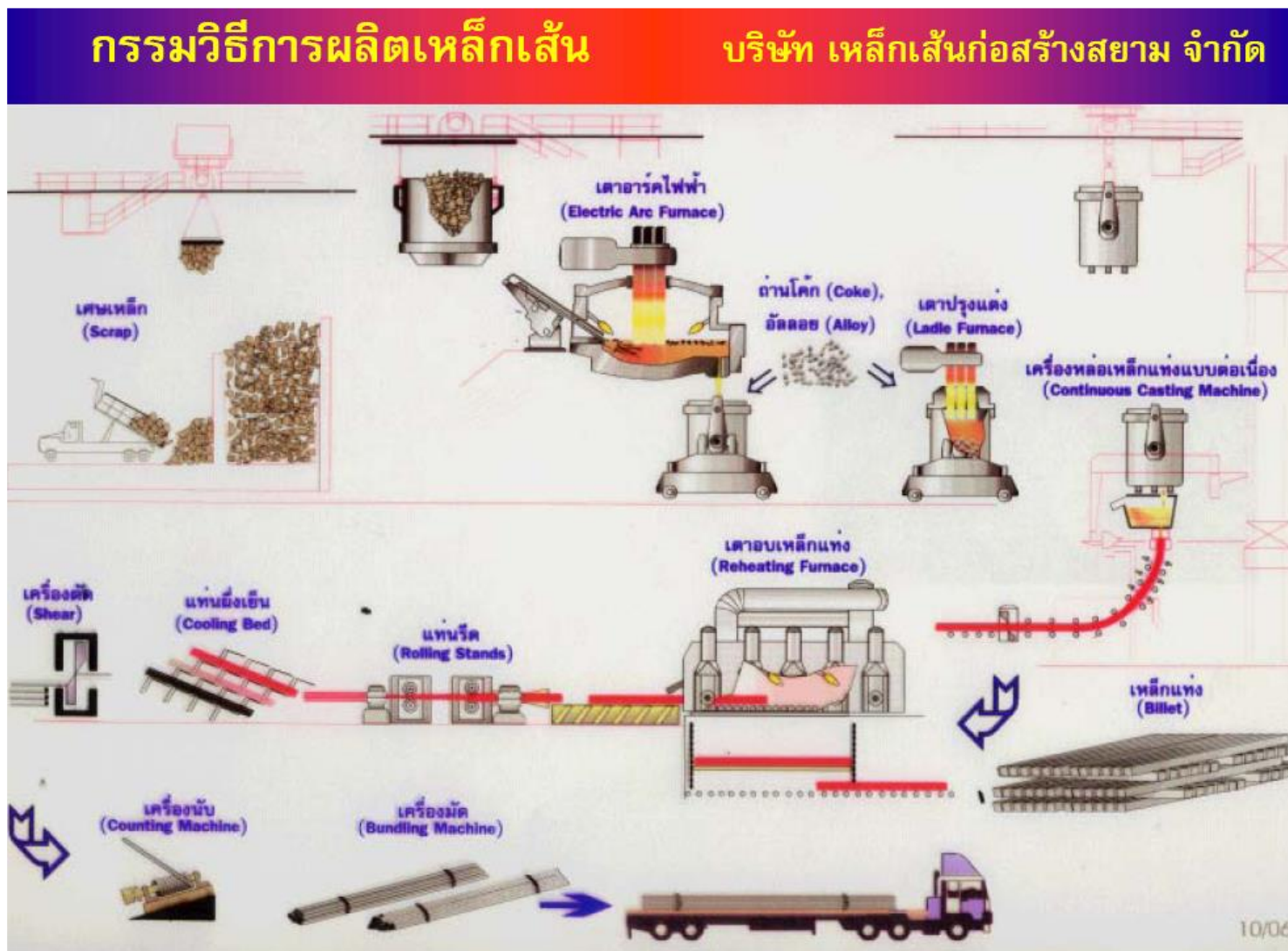
รูปที่ 2-5 แผนผังแสดงกรรมวิธีการผลิตเหล็กเส้น ของบริษัท ทาตา สตีล การผลิต (ประเทศไทย) จำกัด (มหาชน) (บริษัท เหล็กก่อสร้างสยาม จำกัด (เดิม))
