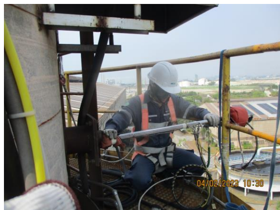
รูปที่ 4-50 ตรวจวัดปล่องของเตาอบเหล็กแท่ง (RHF) ตรวจวัดในวันที่ 4 กุมภาพันธ์ 2566
