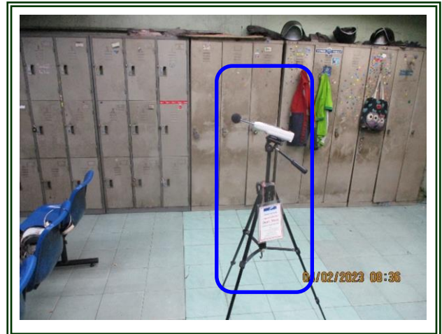
รูปที่ 4-85 ตรวจวัดระดับเสียงในพื้นที่การทำงาน บริเวณเครื่องหล่อเหล็กแท่ง (ห้องควบคุม) ตรวจวัดในวันที่ 4 กุมภาพันธ์ 2566
