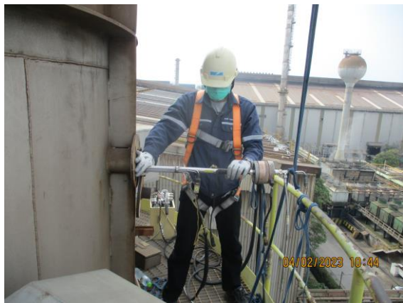
รูปที่ 4-48 ตรวจวัดปล่องที่ผ่านโรงกำจัดฝุ่น (Fume Plant # 2) ตรวจวัดในวันที่ 4 กุมภาพันธ์ 2566
