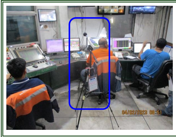
รูปที่ 4-84 ตรวจวัดระดับเสียงในพื้นที่การทำงาน บริเวณเตาหลอมเหล็ก EAF (ห้องควบคุม) ตรวจวัดในวันที่ 4 กุมภาพันธ์ 2566
