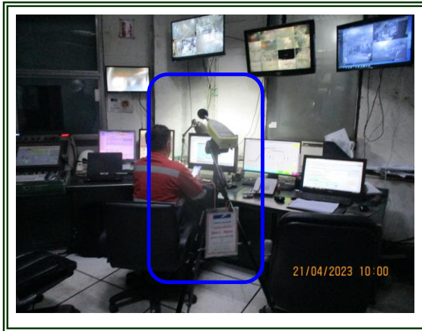
รูปที่ 4-88 ตรวจวัดระดับเสียงในพื้นที่การทำงาน บริเวณเตาหลอมเหล็ก EAF (ห้องควบคุม) ตรวจวัดในวันที่ 21 เมษายน 2566
