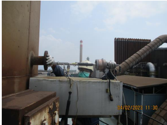
รูปที่ 4-46 ตรวจวัดปล่องที่ผ่านโรงกำจัดฝุ่น (Fume Plant # 1) ตรวจวัดในวันที่ 4 กุมภาพันธ์ 2566
