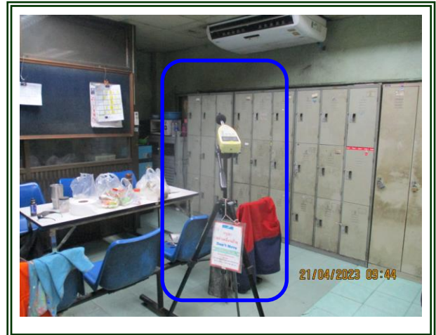
รูปที่ 4-89 ตรวจวัดระดับเสียงในพื้นที่การทำงาน บริเวณเครื่องหล่อเหล็กแท่ง (ห้องควบคุม) ตรวจวัดในวันที่ 21 เมษายน 2566
