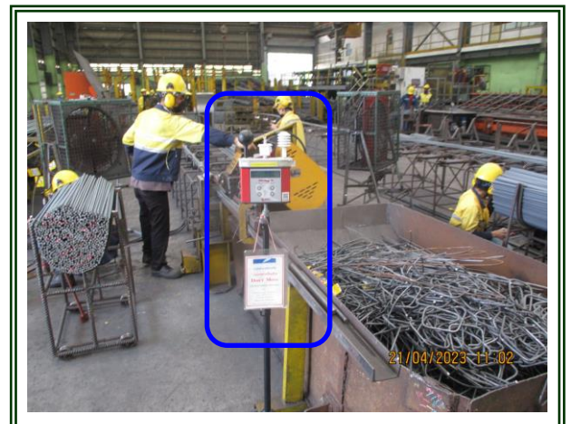
รูปที่ 4-69 ตรวจวัดระดับความร้อนบริเวณจุดผลิตเหล็กเส้นขึ้นรูป ตรวจวัดในวันที่ 21 เมษายน 2566
