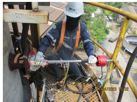
รูปที่ 4-51 ตรวจวัดปล่องของเตาอบเหล็กแท่ง (RHF) ตรวจวัดในวันที่ 21 เมษายน 2566
