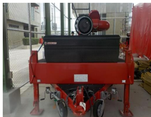
ภาพที่ 2.1-58 ติดตั้งอุปกรณ์ฉีดโฟมดับเพลิง
