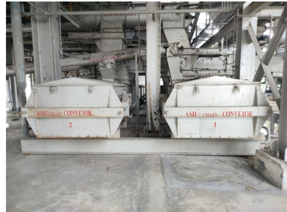
รูปที่ 2-28 ระบบลำเลียงเข้าจากห้องเผาไหม้หม้อไอน้ำมีการปิดครอบมิดชิด
