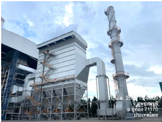
รูปที่ 2-7 อุปกรณ์ดักฝุ่นละอองแบบไฟฟ้าสถิตย์ Electrostatic Precipitator (ESP)
