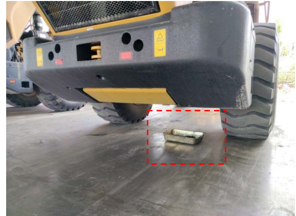
รูปที่ 2-21 วัสดุรองกันการรั่วไหลของน้ำมันที่ใช้แล้ว
