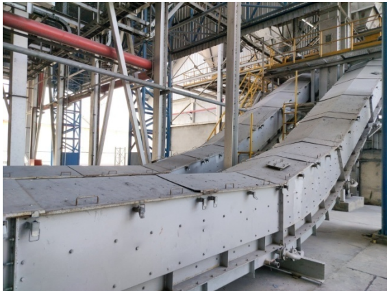
รูปที่ 2-28 ระบบลำเลียงเข้าจากห้องเผาไหม้หม้อไอน้ำมีการปิดครอบมิดชิด
