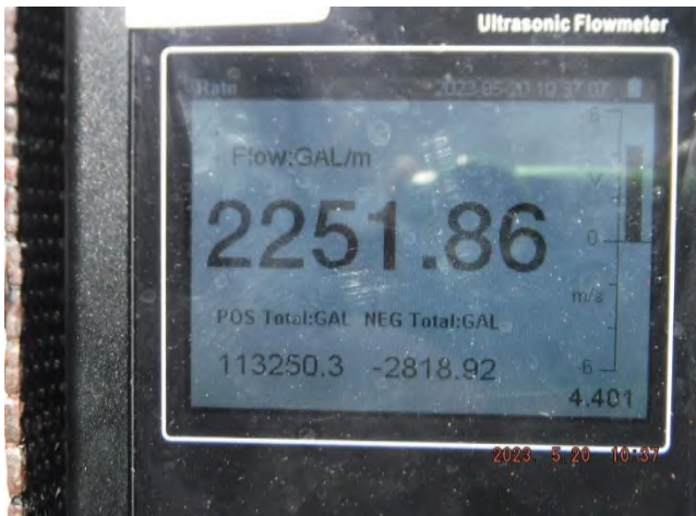
รูปที่ 25 อัตราการไหล (Flow Rate) ที่อ่านค่าได้ เท่ากับ 2,251.86 แกลลอนต่อนาที (gpm.)
