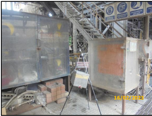
ภาพที่ 3.58 การตรวจวัด H_2S บริเวณพื้นที่ทำงาน RB#2
