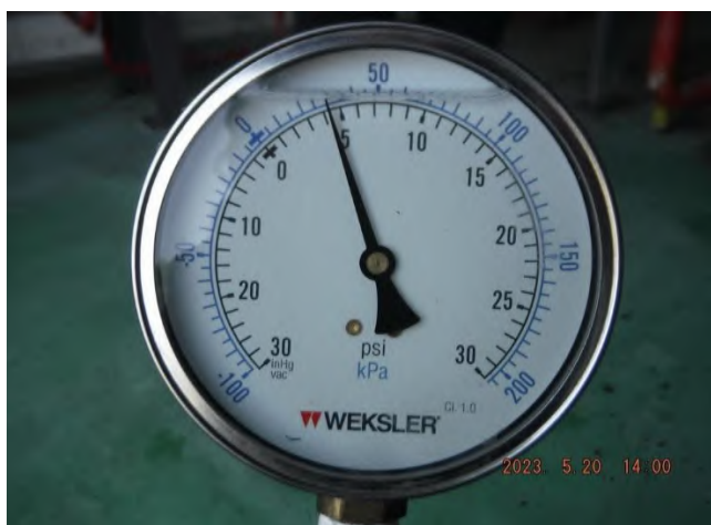
รูปที่ 27 Suction Pressure ที่อ่านค่าได้เท่ากับ 4.2 psi.
