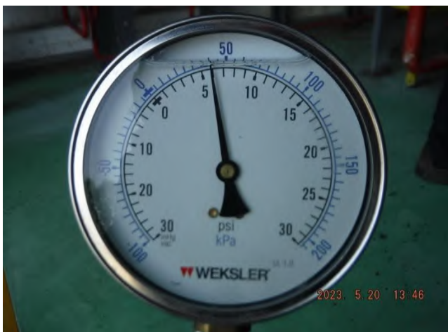
รูปที่ 7 Suction Pressure ที่อ่านค่าได้เท่ากับ 5.9 psi.
