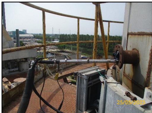
ภาพที่ 3.45 การตรวจวัดปริมาณฝุ่นละออง (TSP) และก๊าซซัลเฟอร์ไดออกไซด์ ( \text{SO}_2 )
