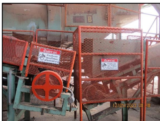
ภาพที่ 2.33 การปิดครอบสายพานเครื่องจักร
