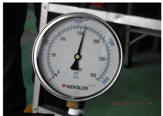
รูปที่ 24 Discharge Pressure ที่อ่านค่าได้เท่ากับ 151 psi.
