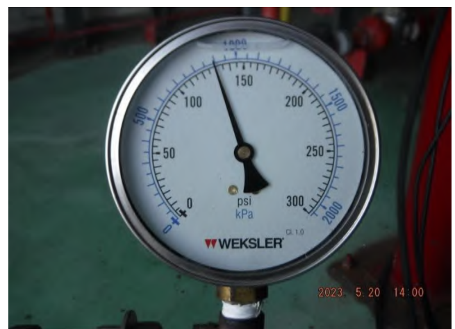
รูปที่ 28 Discharge Pressure ที่อ่านค่าได้เท่ากับ 130 psi.
