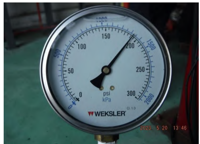
รูปที่ 8 Discharge Pressure ที่อ่านค่าได้เท่ากับ 192 psi.
