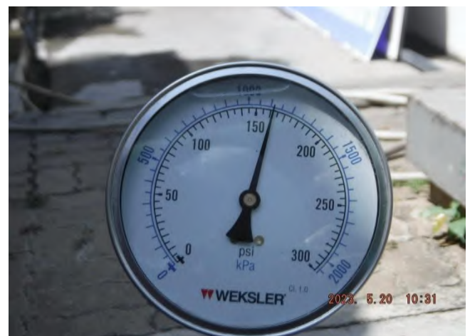
รูปที่ 20 Discharge Pressure ที่อ่านค่าได้เท่ากับ 161 psi.
