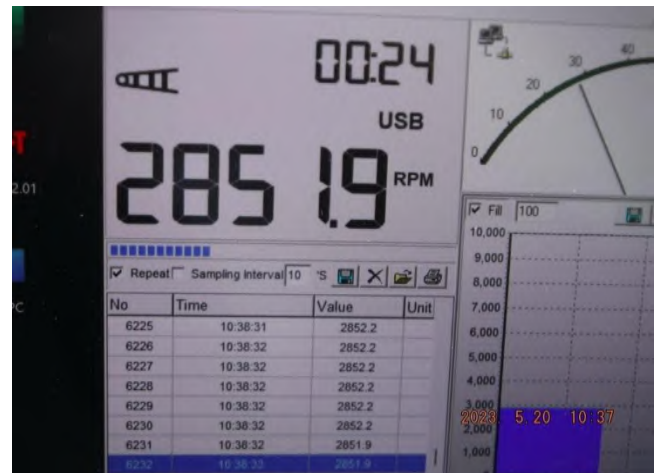
รูปที่ 26 ความเร็วรอบเครื่องยนต์ (Engine Speed) ที่อ่านค่าได้ เท่ากับ 2,851.9 รอบต่อนาที (rpm.)
