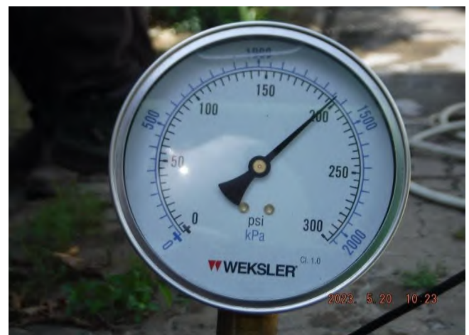
รูปที่ 4 Discharge Pressure ที่อ่านค่าได้เท่ากับ 198 psi.
