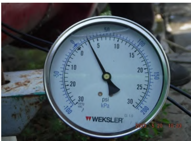
รูปที่ 3 Suction Pressure ที่อ่านค่าได้เท่ากับ 3 psi.
