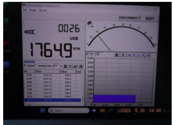
รูปที่ 26 ความเร็วรอบเครื่องยนต์ (Engine Speed) ที่อ่านค่าได้เท่ากับ 1,764.9 รอบต่อนาที (rpm.)
