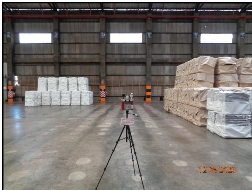
ภาพที่ 3.91 การตรวจวัดระดับความร้อน บริเวณอาคารเก็บสินค้า
