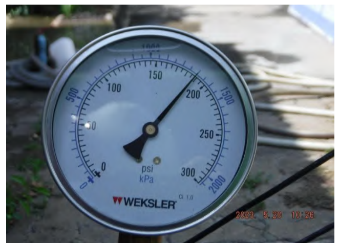
รูปที่ 8 Discharge Pressure ที่อ่านค่าได้เท่ากับ 189 psi.
