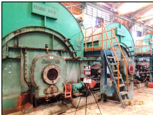
ภาพที่ 3.99 การตรวจวัดระดับความร้อน บริเวณ Washer ฝั่ง Unbleach
