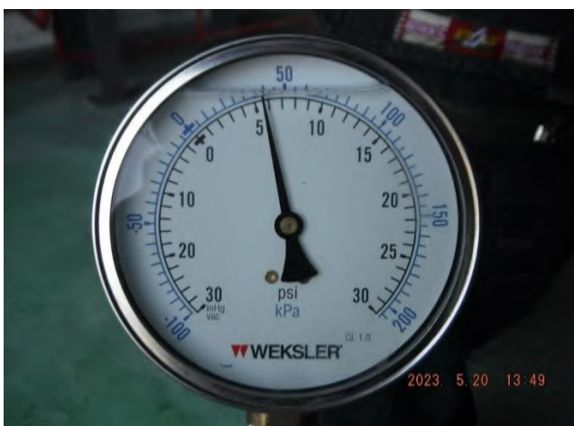
รูปที่ 15 Suction Pressure ที่อ่านค่าได้เท่ากับ 5.6 psi.
