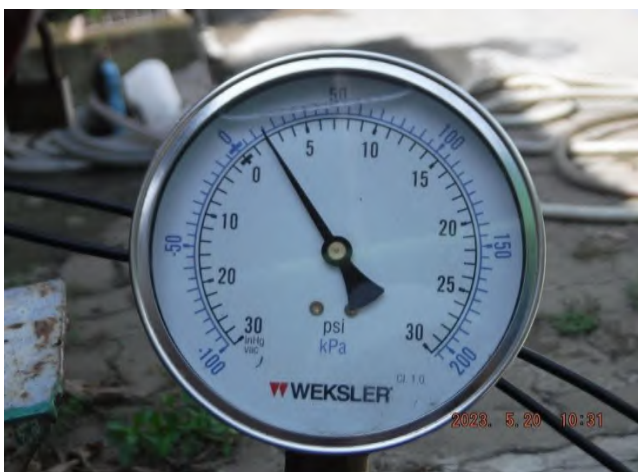
รูปที่ 19 Suction Pressure ที่อ่านค่าได้เท่ากับ 2 psi.
