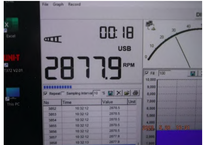
รูปที่ 18 ความเร็วรอบเครื่องยนต์ (Engine Speed) ที่อ่านค่าได้ เท่ากับ 2,877.9 รอบต่อนาที (rpm.)
