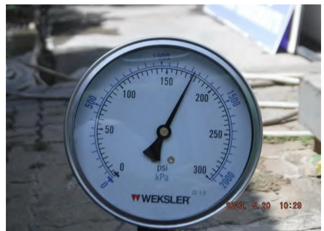
รูปที่ 16 Discharge Pressure ที่อ่านค่าได้เท่ากับ 176 psi.
