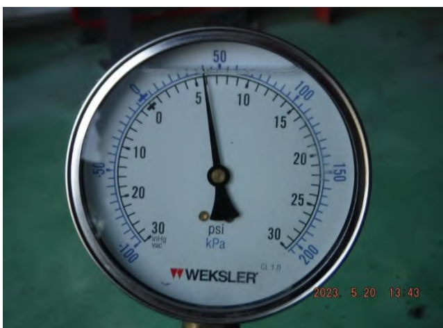
รูปที่ 3 Suction Pressure ที่อ่านค่าได้เท่ากับ 5.9 psi.
