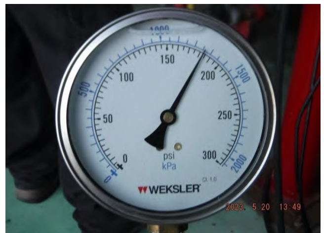
รูปที่ 16 Discharge Pressure ที่อ่านค่าได้เท่ากับ 183 psi.
