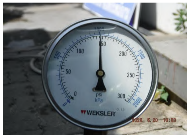
รูปที่ 24 Discharge Pressure ที่อ่านค่าได้เท่ากับ 145 psi.
