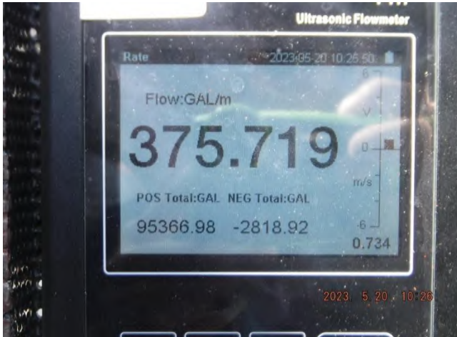
รูปที่ 5 อัตราการไหล (Flow Rate) ที่อ่านค่าได้ เท่ากับ 375.719 แกลลอนต่อนาที (gpm.)
