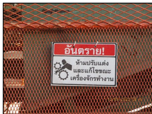
ภาพที่ 2.33 การปิดครอบสายพานเครื่องจักร
