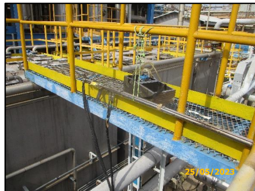
ภาพที่ 3.83 การตรวจวัดก๊าซไฮโดรเจนซัลไฟด์ ( \text{H}_2\text{S} ) ที่ปล่อง Wet Scrubber 2
