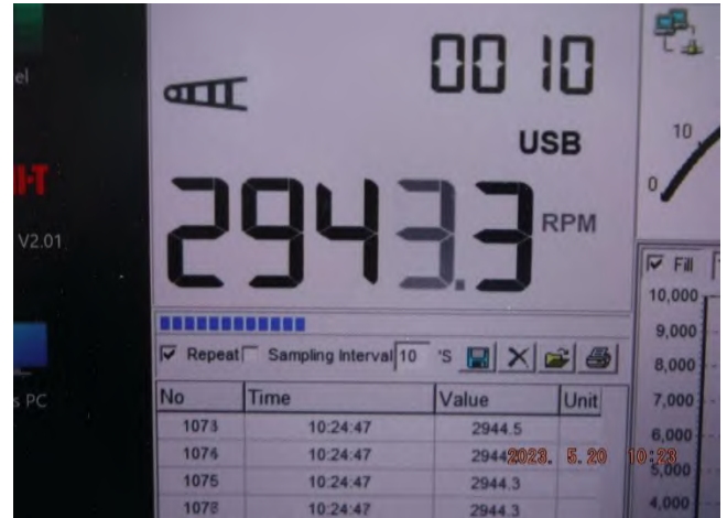
รูปที่ 2 ความเร็วรอบเครื่องยนต์ (Engine Speed) ที่อ่านค่าได้เท่ากับ 2,943.3 รอบต่อนาที (rpm.)
