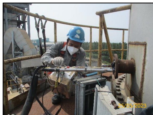
ภาพที่ 3.46 การตรวจวัดปริมาณออกไซด์ของไนโตรเจน ( \text{NO}_x )
