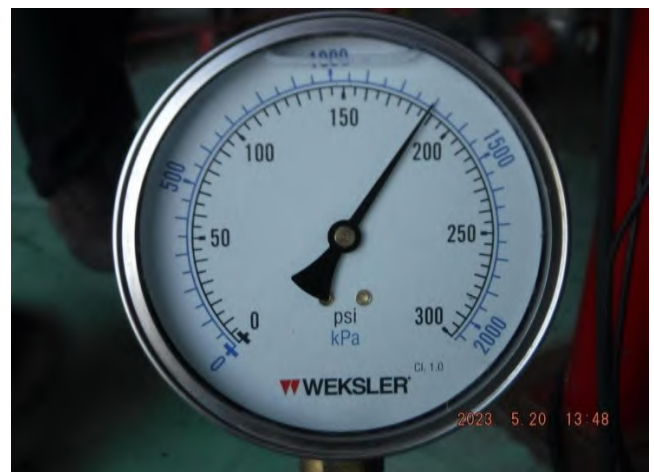
รูปที่ 12 Discharge Pressure ที่อ่านค่าได้เท่ากับ 188 psi.
