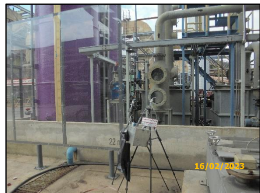
ภาพที่ 3.63 การตรวจวัด Hydrogen Sulfide และ Total Volatile Organic Compound บริเวณ Evap#2
