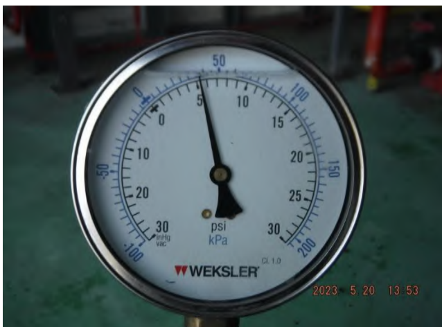
รูปที่ 19 Suction Pressure ที่อ่านค่าได้เท่ากับ 5.2 psi.
