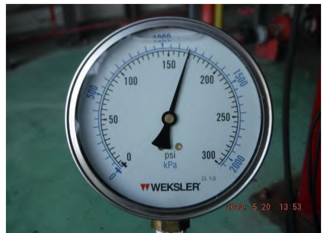
รูปที่ 20 Discharge Pressure ที่อ่านค่าได้เท่ากับ 170 psi.
