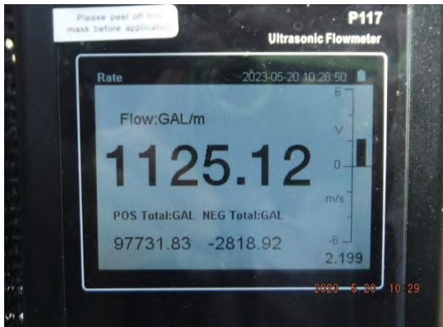
รูปที่ 13 อัตราการไหล (Flow Rate) ที่อ่านค่าได้เท่ากับ 1,125.12 แกลลอนต่อนาที (gpm.)
