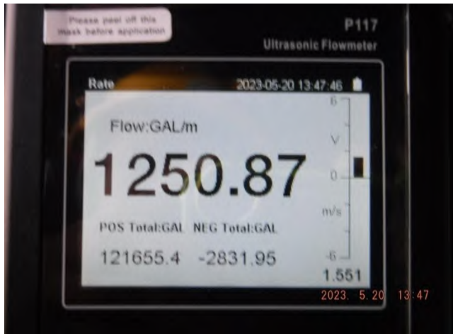
รูปที่ 9 อัตราการไหล (Flow Rate) ที่อ่านค่าได้ เท่ากับ 1,250.87 แกลลอนต่อนาที (gpm.)
