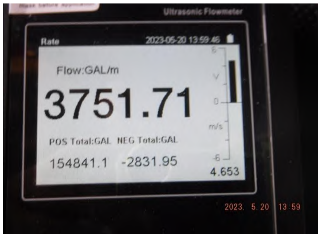
รูปที่ 25 อัตราการไหล (Flow Rate) ที่อ่านค่าได้เท่ากับ 3,751.71 แกลลอนต่อนาที (gpm.)
