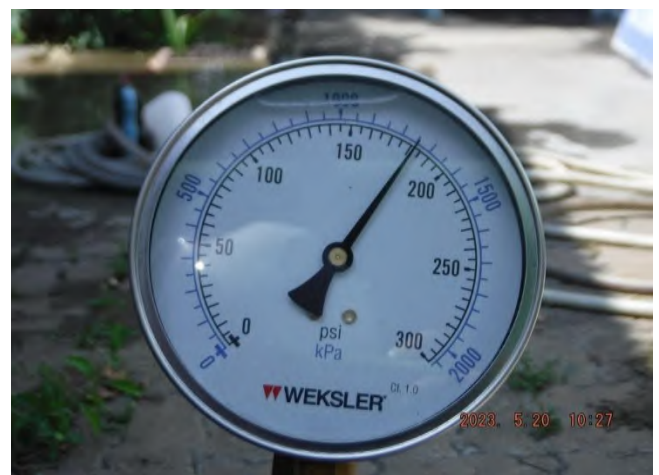
รูปที่ 12 Discharge Pressure ที่อ่านค่าได้เท่ากับ 181 psi.
