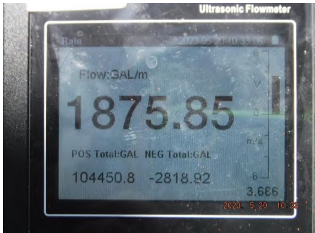
รูปที่ 21 อัตราการไหล (Flow Rate) ที่อ่านค่าได้ เท่ากับ 1,875.85 แกลลอนต่อนาที (gpm.)
