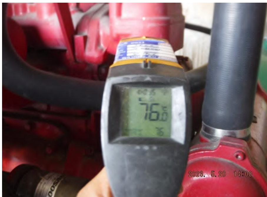
รูปที่ 2 อุณหภูมิของเครื่องยนต์ 76.0 องศาเซลเซียส
