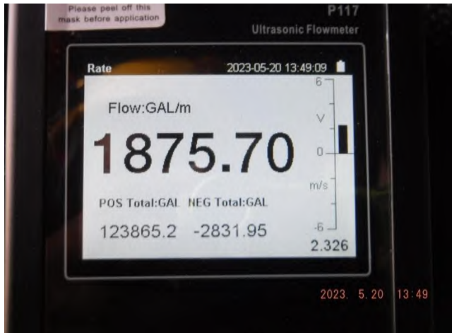
รูปที่ 13 อัตราการไหล (Flow Rate) ที่อ่านค่าได้เท่ากับ 1,875.70 แกลลอนต่อนาที (gpm.)
