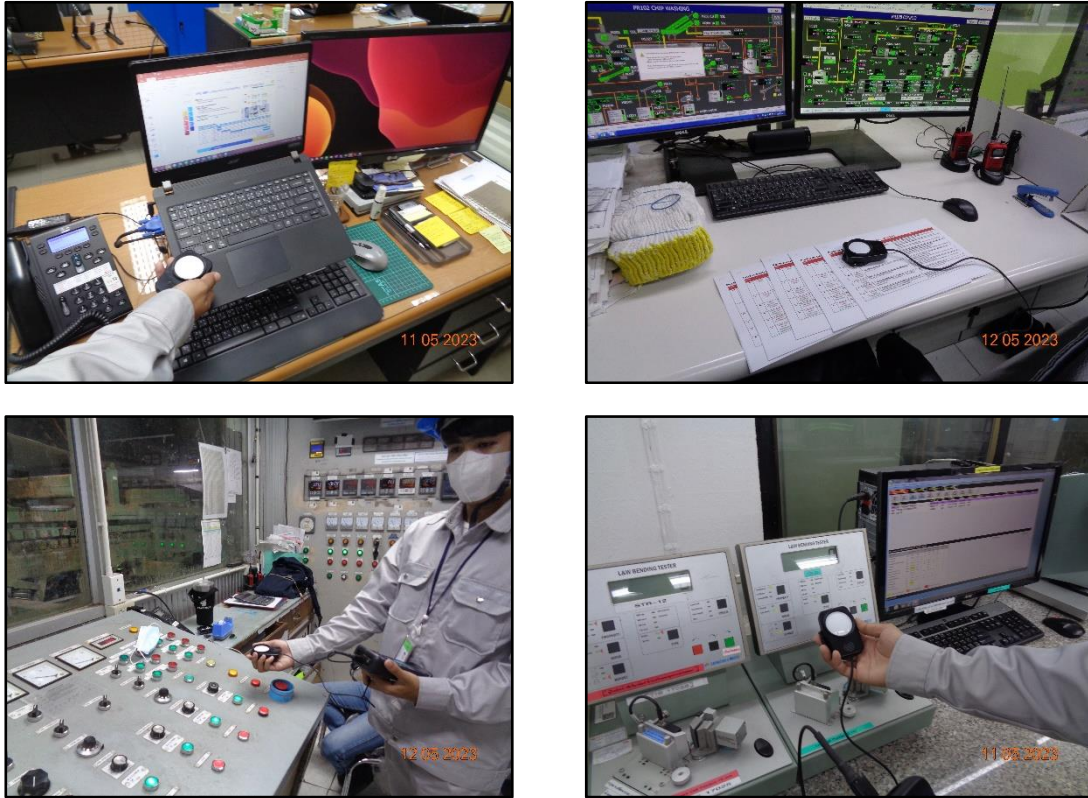
ภาพที่ 3.88 ตัวอย่างการตรวจวัดความเข้มของแสงภายในโรงงาน
