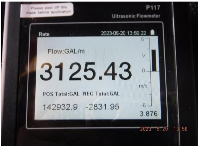
รูปที่ 21 อัตราการไหล (Flow Rate) ที่อ่านค่าได้เท่ากับ 3,125.43 แกลลอนต่อนาที (gpm.)
