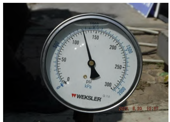
รูปที่ 28 Discharge Pressure ที่อ่านค่าได้เท่ากับ 125 psi.
