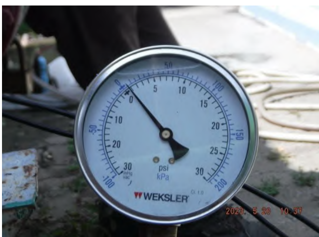
รูปที่ 27 Suction Pressure ที่อ่านค่าได้เท่ากับ 0.8 psi.
