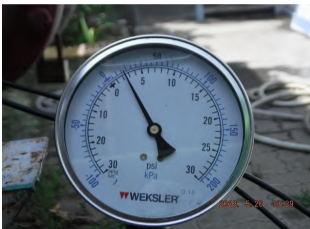
รูปที่ 15 Suction Pressure ที่อ่านค่าได้เท่ากับ 2.5 psi.
