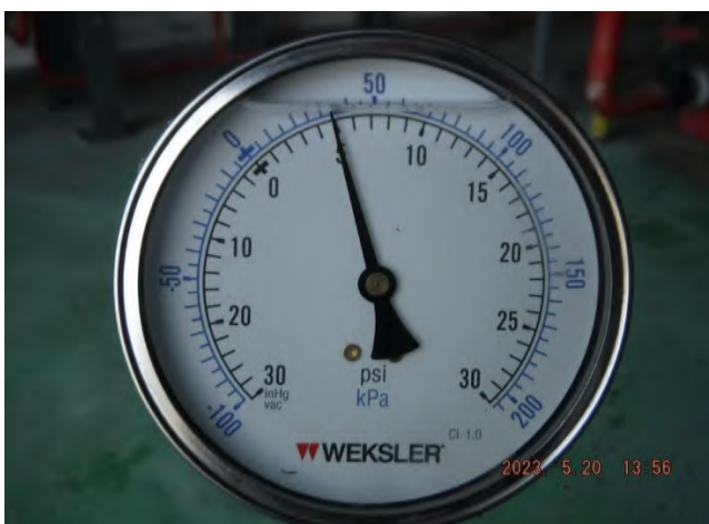
รูปที่ 23 Suction Pressure ที่อ่านค่าได้เท่ากับ 5 psi.
