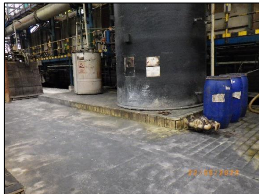
ถังเก็บกากน้ำกรดที่ทำจากวัสดุทนการกัดกร่อน บริเวณพื้นที่รองรับถังเก็บกากที่ทำจากวัสดุทนการกัดกร่อน รูปที่ 2-10 ถังเก็บกากน้ำกรด (จากขั้นตอนการล้างด้วยกรดไฮโดรคลอริก) และบริเวณโดยรอบ
