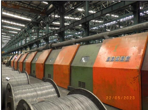
รูปที่ 2-42 การติดตั้งการ์ดของเครื่องจักร ในพื้นที่เสี่ยงอันตราย
