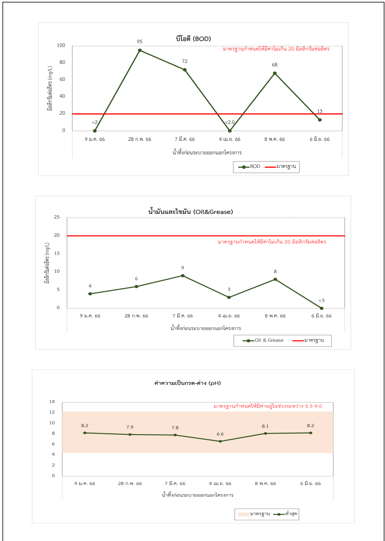
รูปที่ 3.2-1 กราฟเปรียบเทียบผลการตรวจวัดคุณภาพน้ำทิ้ง ระหว่างเดือนมกราคม-มิถุนายน พ.ศ. 2566
