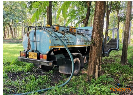
รูปที่ 2-7 การดูดไขมันจากบ่อดักไขมัน
