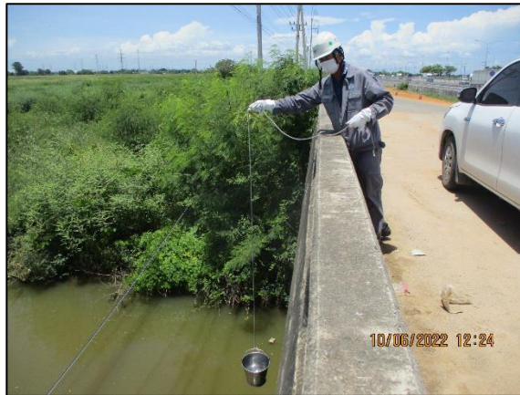
รูปที่ 3.5 การเก็บตัวอย่างคุณภาพน้ำผิวดิน บริเวณคลองอุดมดี-บางจาก ก่อนไหลผ่านโครงการ ประมาณ 1,300 เมตร จากจุดน้ำทิ้ง (SW1)
