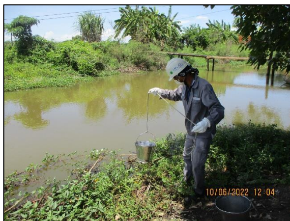
รูปที่ 3.6 การเก็บตัวอย่างคุณภาพน้ำผิวดิน บริเวณคลองอุดมดี-บางจาก (บริเวณจุดระบายน้ำทิ้งของโครงการ) (SW2)
