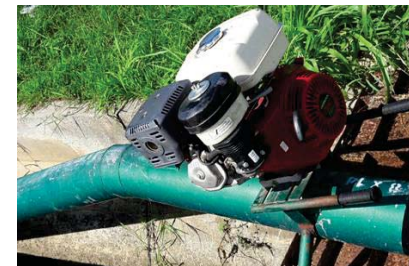
เครื่องสูบน้ำใช้ผลักดันน้ำในรางระบายน้ำฝน เพื่อเพิ่มความเร็วในการระบายน้ำสู่บ่อหนองน้ำฝน 5,500 – 7,800 ลิตร/นาที (1 เครื่อง)
