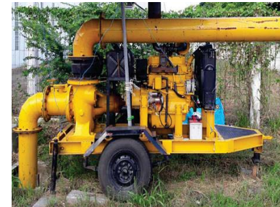
เครื่องสูบน้ำ ใช้ผลักดันน้ำในรางระบายน้ำฝน เพื่อเพิ่มความเร็วในการระบายน้ำสู่บ่อหนองน้ำฝน 918 ลบ.ม./ ชม (1 เครื่อง)
