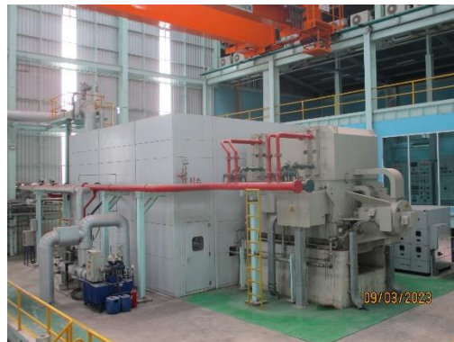
รูปที่ 26 การปิดครอบเครื่องจักรที่มีเสียงดัง
