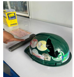
หมวกนิรภัยที่ถูก Stud bolt ตกกระแทก
