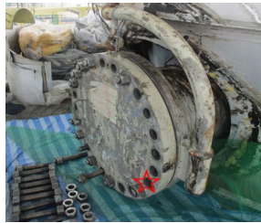
ตำแหน่งของ Stud bolt ที่ร่วงหล่น
