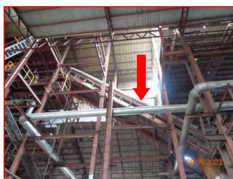
ภาพที่ 2.2-14 อุปกรณ์ครอบระบบสายพาน ป้องกันฝุ่นฟุ้งกระจาย
