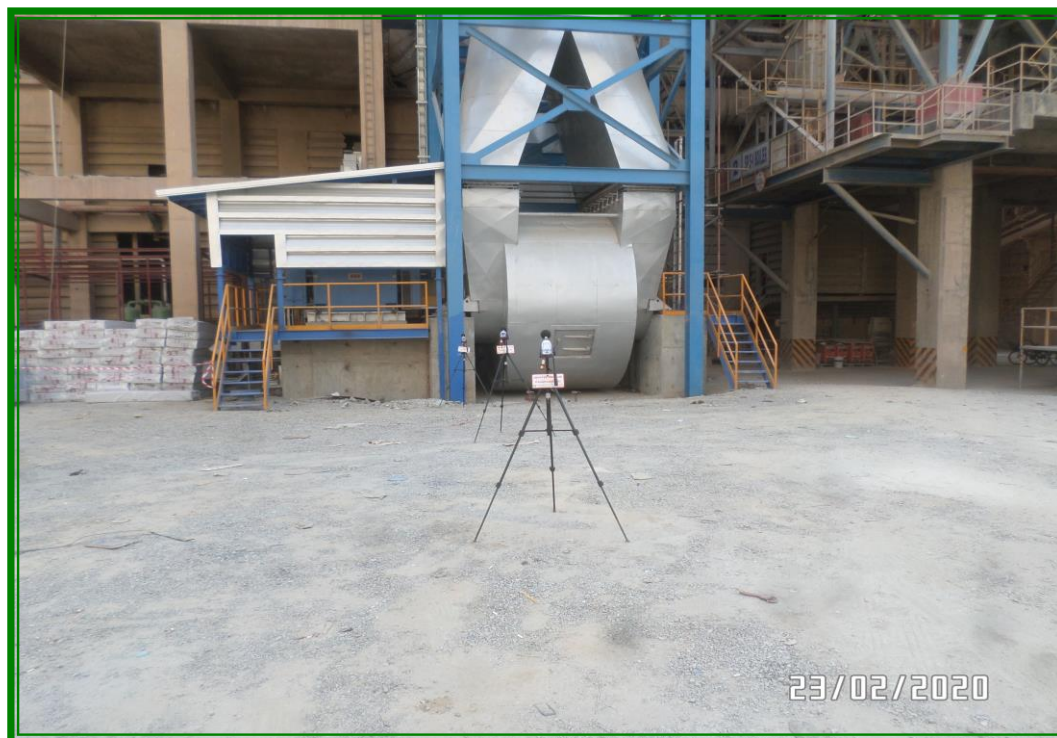
ภาพถ่ายการตรวจวัดระดับเสียงในสถานที่ทำงาน อาคาร Preheater (บริเวณ Blower Bag Filter)
