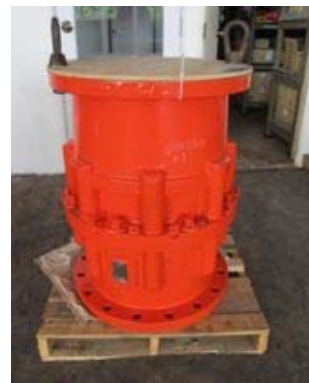
รูปที่ 3-33 อุปกรณ์ตัดแยกน้ำมันฉุกเฉิน (Break Away Coupling)
