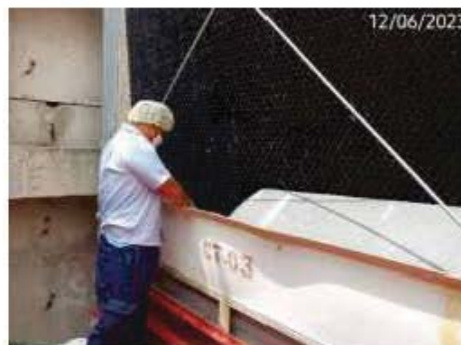
ภาพที่ 3.5.4-1 การเก็บตัวอย่างน้ำบริเวณที่เข้าและออกห่อฝิ่งเย็น
