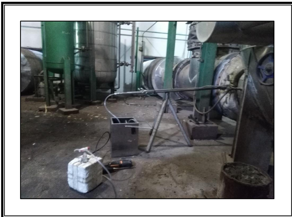
รูปที่ 3.7 จุดตรวจวัดคุณภาพอากาศจากปล่องปล่อยทิ้งอากาศเสีย บริเวณปล่อง Waste Heat Boiler ที่ต่อกับเครื่องยนต์ Caterpillar No.2 ในวันที่ 8 ตุลาคม พ.ศ. 2563
