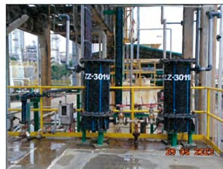
รูปที่ ก2-7 Carbon Canister ที่ใช้กำจัด Vent gas จาก CPI Separator
