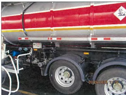
รูปที่ ก2-10 ระบบขนถ่ายด้านล่าง (Bottom loading) ในรถขนส่งผลิตภัณฑ์
