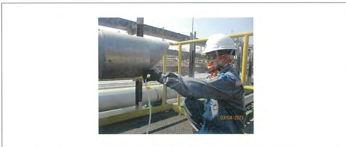
ภาพที่ 3-5 การตรวจวัดความเข้มข้นของ Mixed Xylene ที่ระบายออกจากปล่อง Carbon Canister
