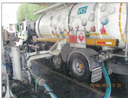
รูปที่ ก2-11 Vapor Return Line
