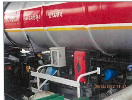
รูปที่ ก2-10 ระบบขนถ่ายด้านล่าง (Bottom loading) ในรถขนส่งผลิตภัณฑ์
