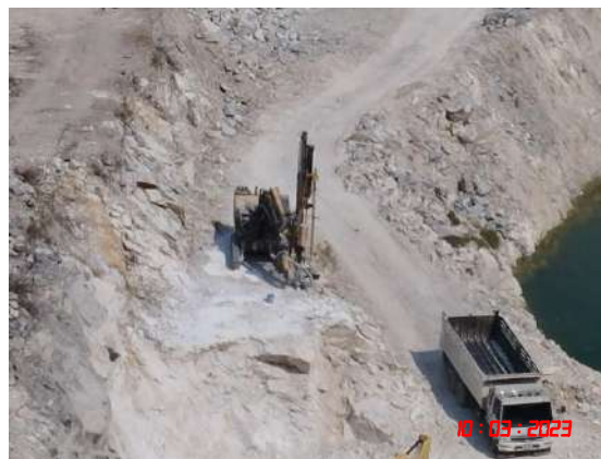
รูปที่ 4 รถเจาะระเบิดที่มีอุปกรณ์เก็บฝุ่นติดไว้กับหัวเจาะ
