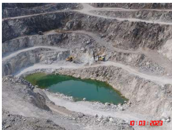
รูปที่ 11 บ่อรับน้ำ (Sump) ในชุมเหมือง
