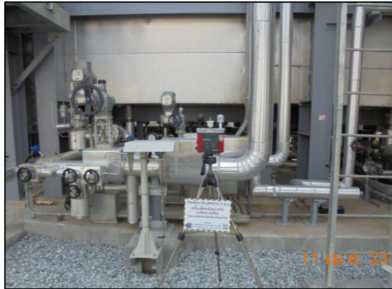
รูปที่ 3-15 การตรวจวัดระดับความร้อนในพื้นที่ทำงาน บริเวณ หม้อไอน้ำ
