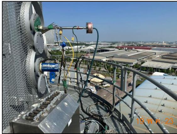
รูปที่ 3-1 การเก็บตัวอย่างคุณภาพอากาศในปล่องระบาย บริเวณ HRSG21
