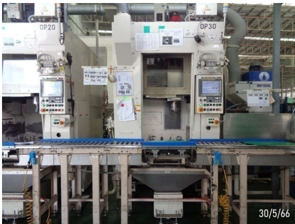
รูปที่ 3-33 การติดตั้งเครื่อง CNC ระบบปิด
