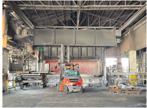
เตาหลอมพักน้ำอะลูมิเนียม ขนาด 26 ตัน
