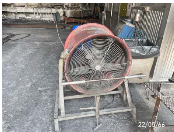
รูปที่ 2-31 ระบบระบายอากาศบริเวณพื้นที่วาง Coil ร้อน
