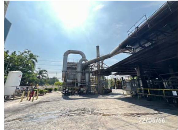
รูปที่ 2-1 ระบบดักฝุ่นละอองแบบถุงกรอง
